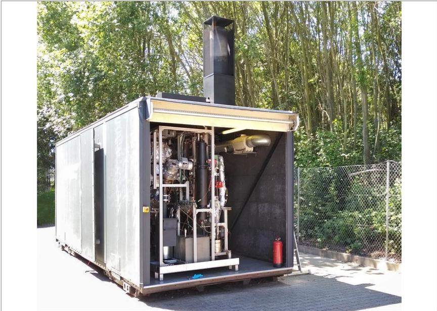
**Abbildung 18:** Prototypanlage Biofabrik Dresden mit einem Modul
