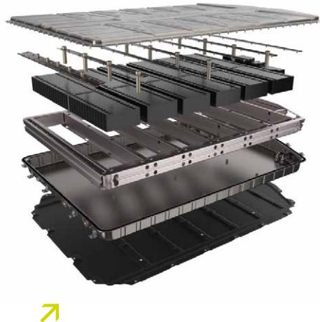
Batteriekühlung: Komponenten von oben nach unten: Batteriedeckel aus Stahl oder Aluminium, Batterie Packs, Hochvoltspeicher aus flexibel gewalztem Stahlblech, Kühlwanne aus Aluminium-Legierungen, Unterfahrschuss aus CFK
