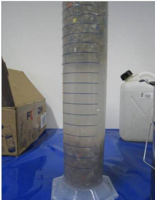
Abbildung 1: Trennung von Kunststoffen unterschiedlicher Dichte.
