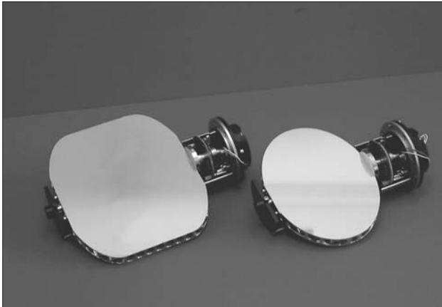
Abb. 3: Scannermodul für den Einsatz in Flugzeugen
