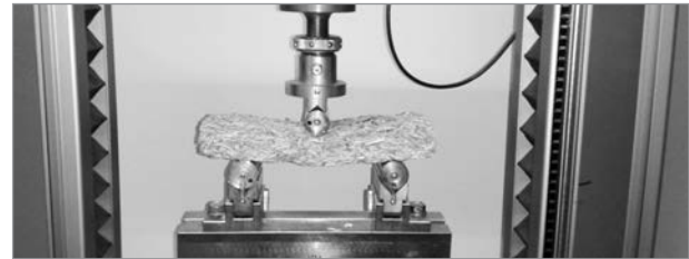
Dreipunkt-Biegezugversuch an Miscanthus-Dämmplatten
