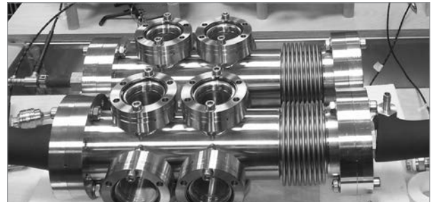
Sorptionsmodule einer Laborwärmepumpe
